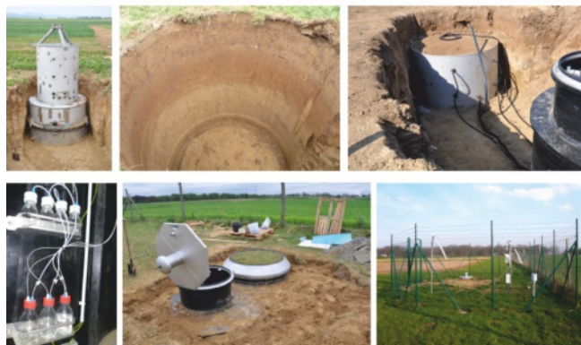
Obr. 1: Lyzimetrická stanica postavená v lokalite experimentálnych poličok Výskumného ústavu rastlinnej výroby NPPC, pracovisko Borovce pre účely riešenia poľnohospodárskeho a environmentálne zameraných výskumných úloh (foto: J. Gubiš).
